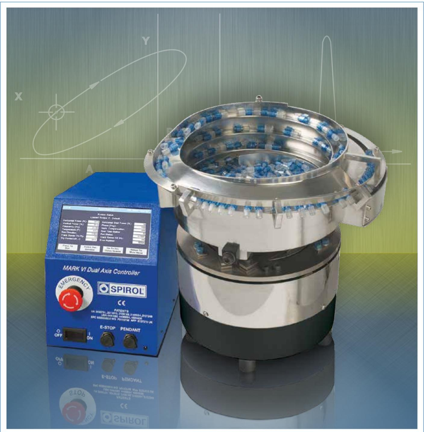
Dank der Kombination von Frequenz, Amplituden und Phasenregelung sind die Vibrationsantriebe der Serie 2000 von **SPIROL** herkömmlichen Zuführsystemen weit voraus.
