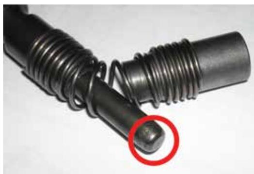
Bild 3: Verschlossener Einpressdorn
