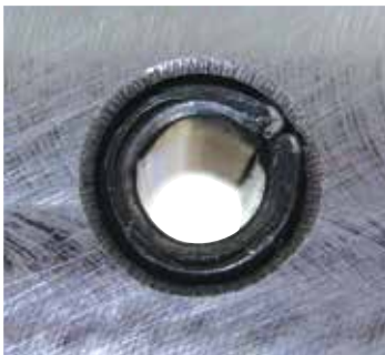
Abbildung 2: Der Spalt einer geschlitzten Spannhülse ist geschlossen, wenn er in eine Bohrung montiert ist.
