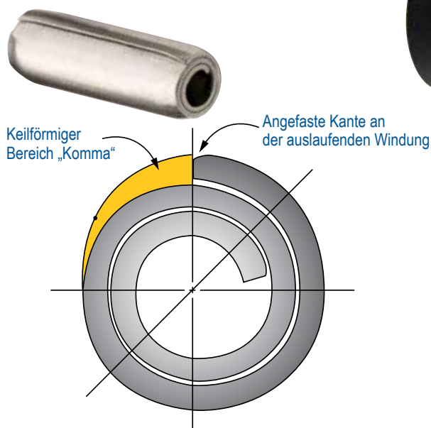
Abbildung 3: Die auslaufende Windung des Spiralspannstifts verfügt über eine Fase die sicherstellt, dass an der auslaufenden Windung keine vorstehende Kante vorhanden ist und ein fließender Übergang in den keilförmigen Bereich erzielt wird.
