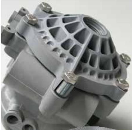
In Anwendungen wo das Gegenstück auch aus Kunststoff ist ist ein Compression Limiter notwendig, um Kriechen zu verhindern oder Druckfreisetzung im Gegenstück durch Reduzierung der Reibkraft in der Verbindung.
