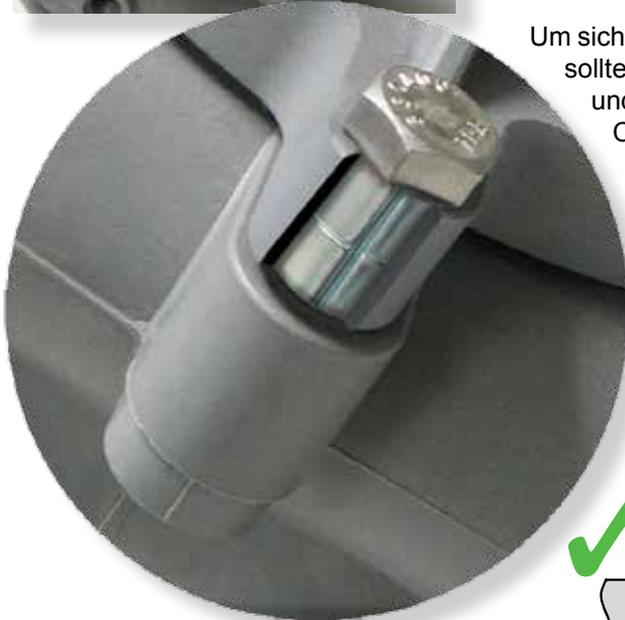
Um sicherzustellen dass die Compression Limiter richtig verwendet werden sollten Sie an den Gewindeeinsatz anstossen so dass der Gewindeeinsatz und nicht der Kunststoff die Last trägt. Der Innendurchmesser des Compression Limiter des Gegenstücks muss grösser sein als der Aussendurchmesser der zu montierenden Schraube aber kleiner als der Führungszapfen oder der Durchmesser des Gewindeeinsatzes um ein Herausziehen zu vermeiden.
