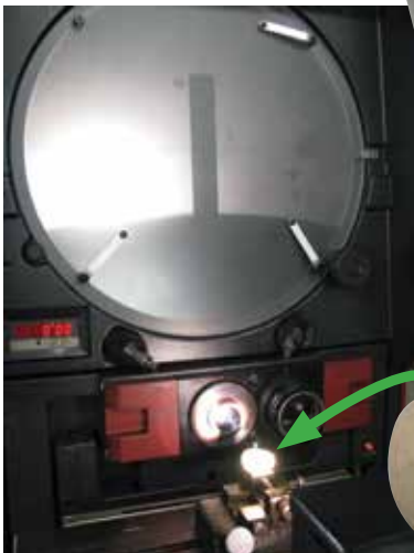
Abbildung 6b. Stift in Modelliermasse mit Profilprojektor
