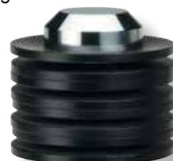
Im laufenden Betrieb ändert sich die Zugspannung in eine Druckspannung. Die Ermüdungsbeständigkeit wird durch diese Spannungsumkehr drastisch reduziert. Das Aufrechterhalten einer konstanten Vorspannung von mindestens 15% Einfederung verhindert diese Spannungsumkehr und erhöht die Lebensdauer der Tellerfeder.
