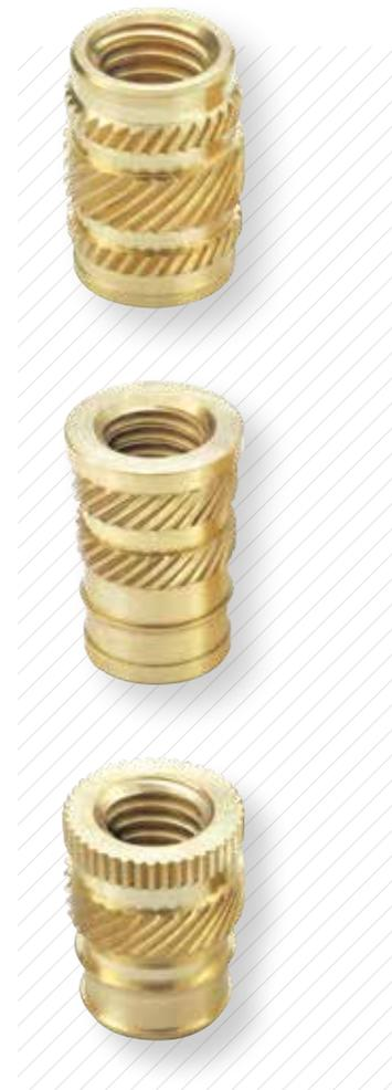
Die **richtige Bohrungsgröße** ist entscheidend. Größere Aufnahmebohrungen verringern die Leistungsfähigkeit, während kleinere Aufnahmebohrungen zu unerwünschten Spannungen und möglichen Rissen im Kunststoff führen. Unterdimensionierte Aufnahmebohrungen können auch zu Gratbildung am Rand der Bohrung führen und die Installation des Gewindeeinsatzes erschweren.
