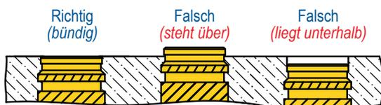
Top of the Insert should be installed as close to flush as possible. Die Oberseite des Gewindeeinsatzes sollte möglichst bündig mit der Oberfläche des Kunststoffes abschließen.
