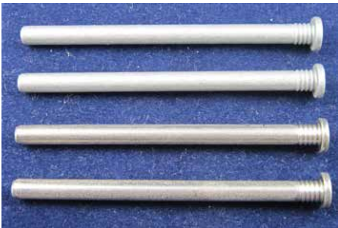
Abbildung 5: Stifte vor dem Test: Die oberen beiden sind aus kohlenstoffarmem Stahl, der mit Zinklamellen beschichtet ist, die unteren beiden sind gefertigt aus austenitischem Edelstahl AISI 305
