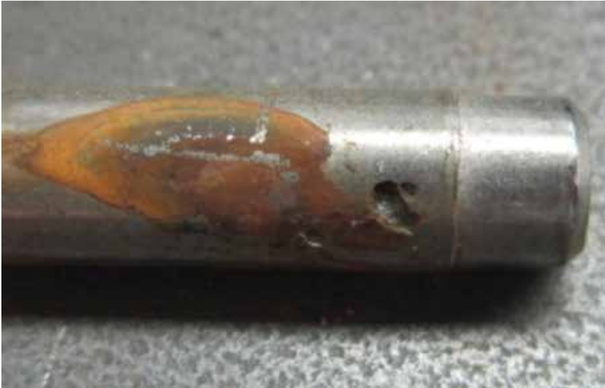
Abbildung 9: Lochfraß mit entsprechender Verfärbung auf einem aus Edelstahl AISI 410 gefertigten Vollstift
