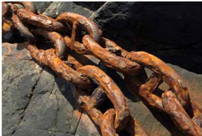
Abbildung 1. Die verrostete Kette zeigt Materialverluste durch Rost oder allgemeine Angriffe.
