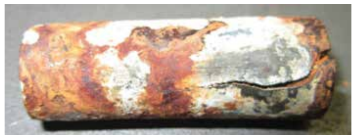
Abbildung 2: Dieser Spiralspannstift wurde mit einer leichten Verzinkung und anschließender Chromatierung versehen. Diese Beschichtung wurde eingestuft mit einer Korrosionsbeständigkeit von 48 Stunden gegen Rotrost. Wenn man diesen Spiralspannstift 200 Stunden im Salzsprühnebeltest belässt, führt das zu einem erheblichen Rotrost, obwohl noch etwas Zink und Weißrost vorhanden ist. Wenn Zink auf der Oberfläche vorhanden ist, bleibt das Produkt trotz der Schwere des Angriffs in angrenzenden Bereichen frei von Rotrost.
