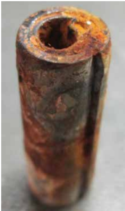
Abbildung 3: Dieses Foto zeigt die Grundgeometrie eines Spiralspannstifts, sie besteht aus einer Reihe von Metallwicklungen. Zwischen den Wicklungen dringt keine Beschichtung ein. Tauchlacke können zwar den Innenbereich abdecken, bleiben aber zwischen den Wicklungen des Spiralspannstifts unwirksam.
