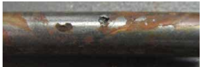
Abbildung 7: Lochfraß mit entsprechender Fleckenbildung auf einer geschlitzten Spannhülse aus Edelstahl AISI 420
