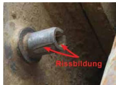
Abbildung 3: Eine geschlitzte Spannhülse kann sich nur 180° gegenüber dem Schlitz entlang ihres Rückens biegen, so ähnlich wie beim Öffnen und Schließen eines Buches.
