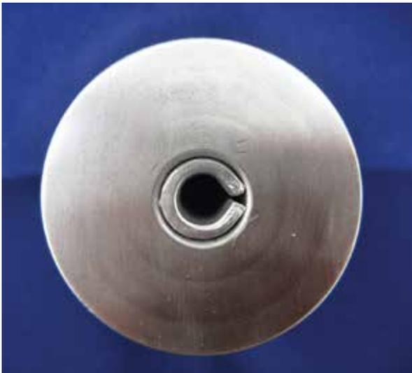
Abbildung 5: Geschlitzte Spannhülse, die in einer empfohlenen Aufnahmebohrung installiert ist. Beachten Sie, dass der Schlitz entlang des Innendurchmessers des Stiftes praktisch geschlossen ist.
