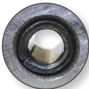
Die geschlitzte Spannhülse ist bei geschlossenem Schlitz nicht mehr radial elastisch.
