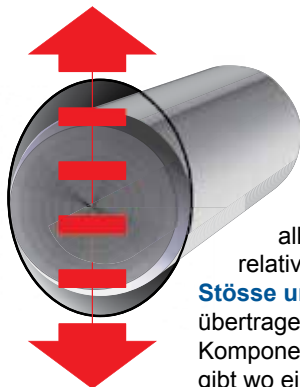
Die Steifigkeit des Zylinderstiftes vergrössert das Loch.
