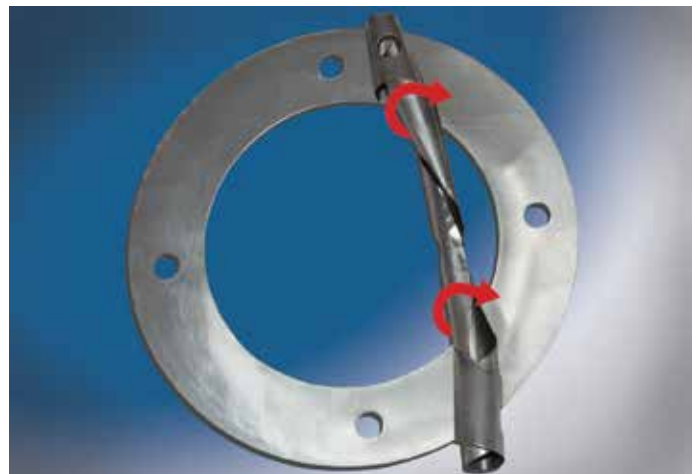
Unerwünschte Deformation bei oberflächengebundenen laminierten Zwischenlagen.
