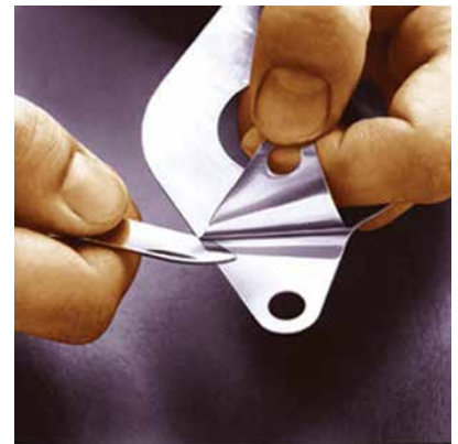
Laminierte Passscheiben können Schicht für Schicht abgeschält werden, bis sie die richtige Dicke haben.
