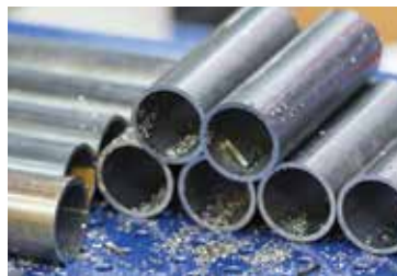
Grat an den Enden von abgelängten Metallrohren
